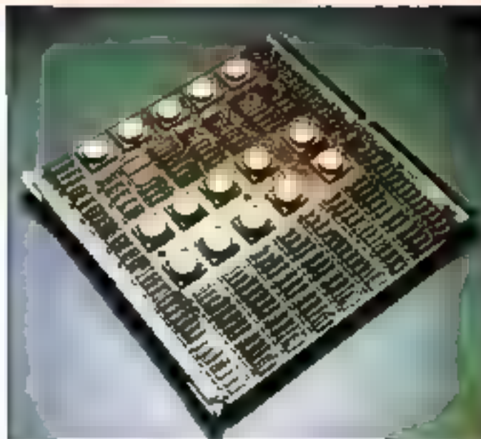
Dans les Eclisse MV 15000 modèles 8, 10 et 20, l'architecture microprogrammée 32 bits tient sur une seule carte
